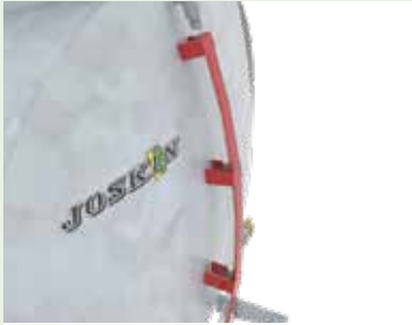
Beschermde niveaumeter , buiten bereik van de dieren.
